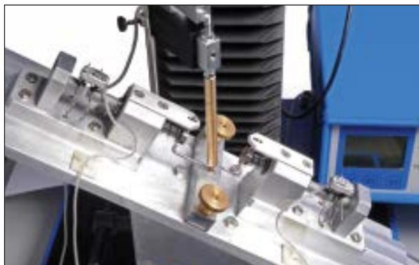
**Fig. 1** Configurazione sperimentale con un assemblaggio impianto-moncone inglobato in una barra di alluminio e posizionato in una macchina di prova universale con un angolo di 30 gradi rispetto all'asse lungo dell'impianto; la barra verticale color ottone rappresenta l'applicatore di carico. Le sonde meccaniche si toccano (*Sinistra*) la spalla dell'impianto e (*Giusto*) il moncone per trasferire qualsiasi movimento agli estensimetri posizionati a distanza.
